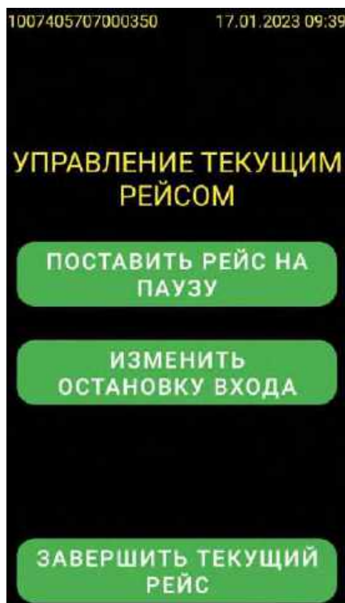
Рисунок 11 – Меню служебного режима в состоянии «движение» для маршрута с дифференцированной (зонной) оплатой
